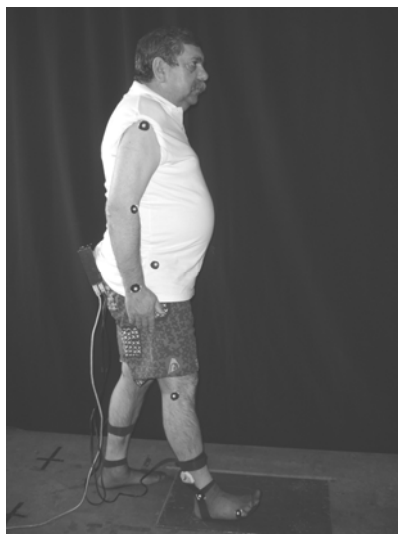
Figura 25: Plataforma de forças, palmilhas transdutoras de pressão plantar e marcadores reflectores nos pontos de referência anatômicos a digitalizar.
