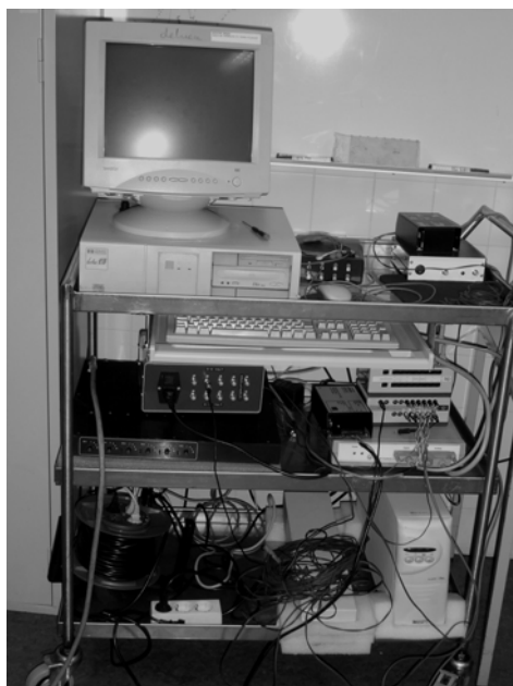
Figura 24: Amplificador, interface Biopac UM100 e conversor analógico-digital de 16 bits da marca Biopac.
